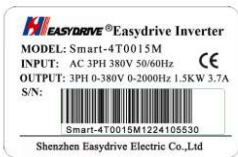
Рис. 1-2 Паспортная табличка инвертора
